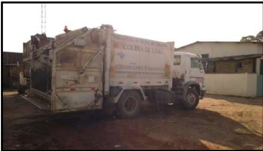
Figura 40 - Caminhão Compactador Utilizado na Coleta de Resíduos Sólidos Urbanos
