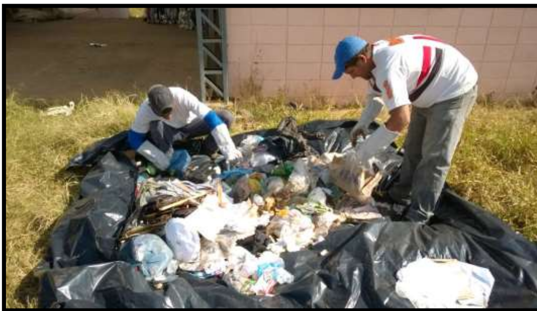
Figura 35 - Realização do Ensaio de Composição Gravimétrica em Itirapina
