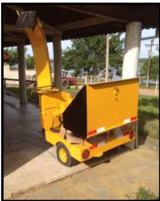
Figura 65 – Triturador de galhos e podas
