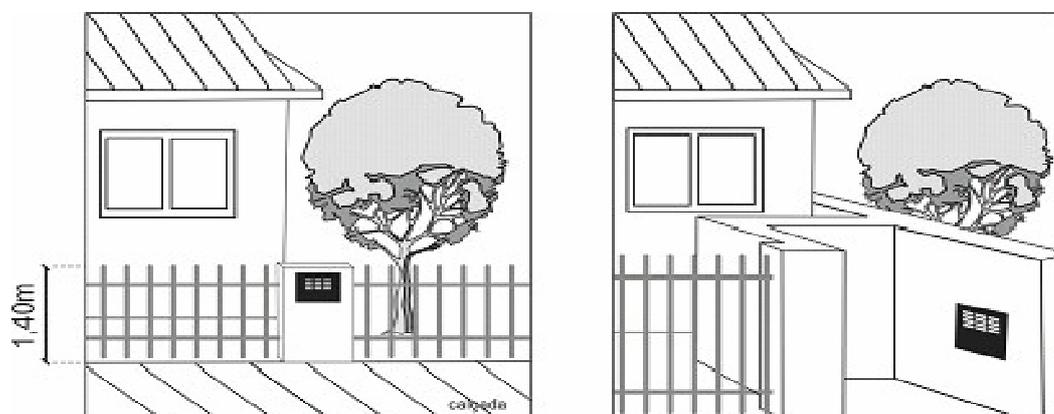
**2 – Instalação Lateral:** Para instalação lateral será necessário deixar um recuo no muro ou grade frontal para garantir o acesso ao hidrômetro pela calçada. A largura deste recuo deverá ser no mínimo de 01 (um) metro e ainda permitir a abertura total da tampa.
